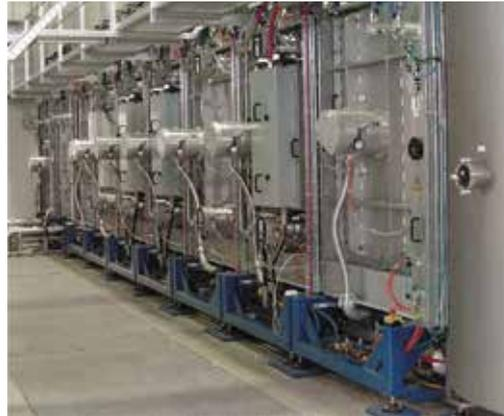
Inline-Vakuumbeschichtungsanlage ILA 900
