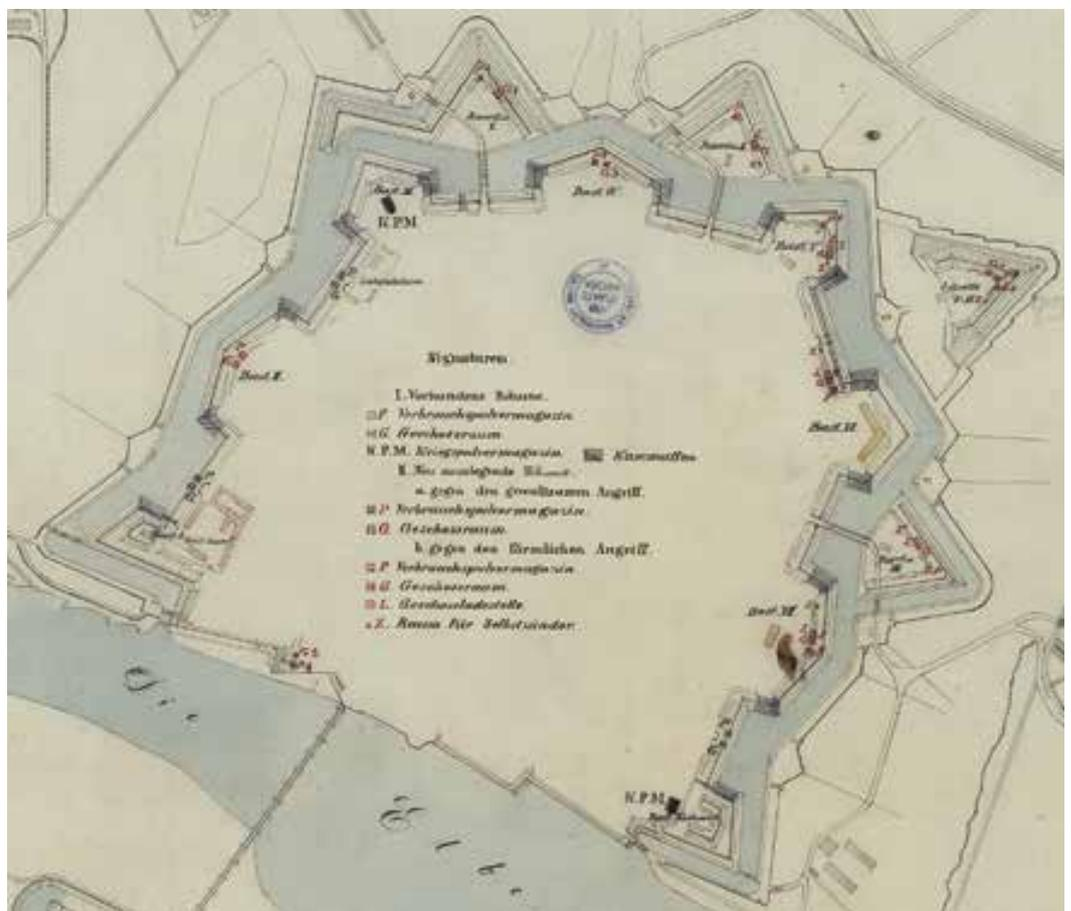
In dem Riss des Hauptwerks der Festung Torgau von 1867 sind alle vierzehn Flankenkasematten als kleine dunkle Flächen gut erkennbar.
