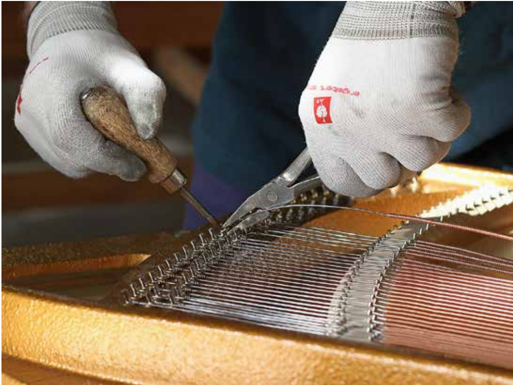
Die Saiten eines Instruments werden von Hand aufgezogen, Basssaiten zusätzlich mit Kupfer umspinnen.
