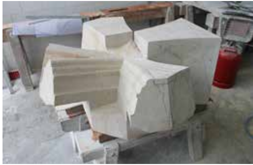
Steinschnitt eines Rippenknotens der Dresdner Schlosskapelle, gefertigt bei Fuchs & Girke in Ottendorf-Okrilla Foto: Thomas Bauer
